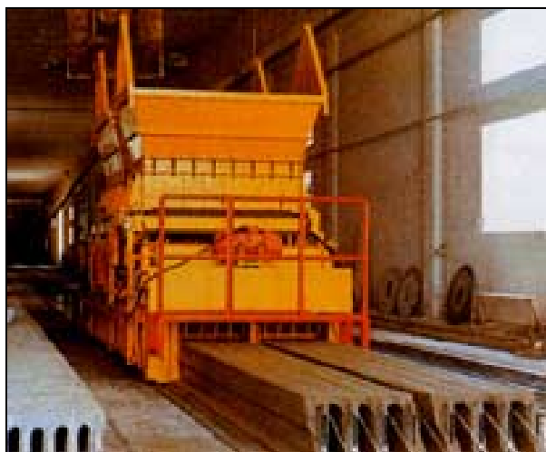
Figura 3. Macchina vibrofinitrice e solai alveolari realizzati con procedimento "slip-form"
